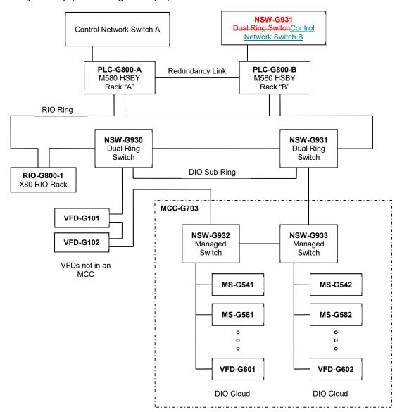
Figure 3-2: M580 Hot-Standby Architecture
